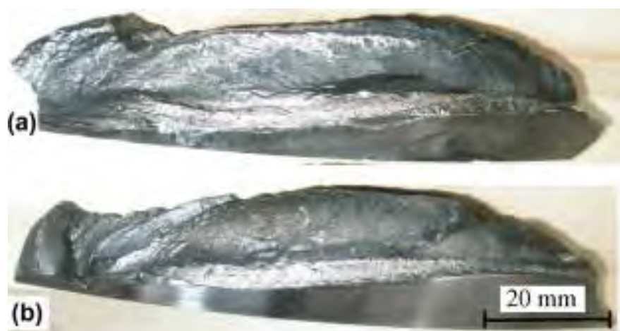
Рис. 3. Сломанное коническое зубчатое колесо ГВРК морского буксира [2-5]
