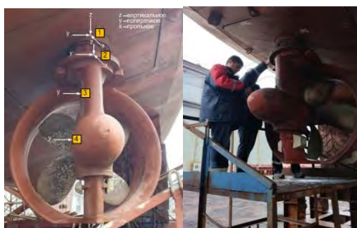
Рис. 5. Место установки датчиков вибрации на ГВРК типа SRP 300/226 фирмы «Schottel» правого и левого борта морского буксира в а) процессе эксплуатации; б) сухом доке
