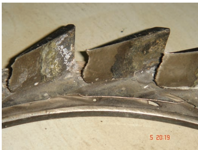
Рис. 1. Повреждение соплового аппарата ТК типа NR
