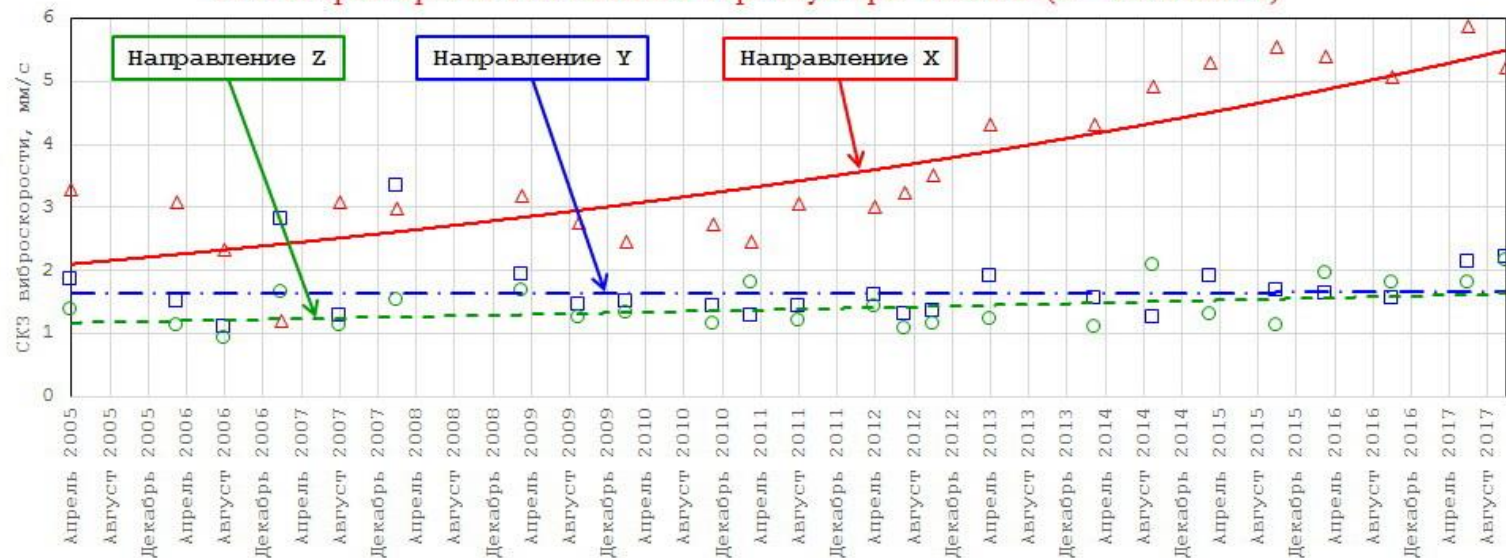
СКЗ виброскорости ГВРК левого борта буксира. Точка 2. ( n = 1500 мин-1)
